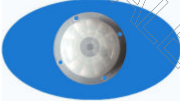
型号：8605-4 焦距：15 角度：100° 距离：6m 尺寸：内径 33.95 外径 43.5
