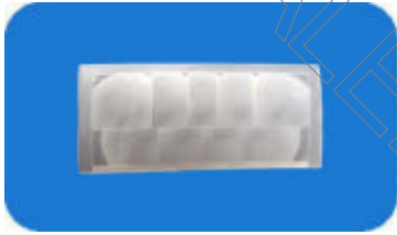
型号：7601-4 焦距：21.7 角度：110° 距离：17m 尺寸：66 X 28.5
